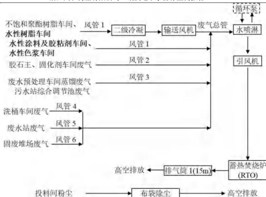
图4.1-16 全场废气处理工艺流程示意图
